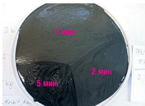
Рис. 25. Консистенция раствора должна быть такой, чтобы обеспечивалось полное заполнение швов. Время перемешивания раствора для заполнения швов должно составлять не менее 3-4 мин.
