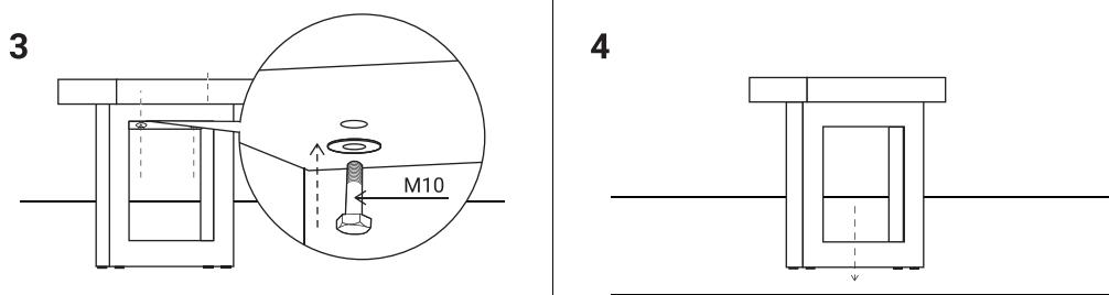
Убедитесь, что все крепления надежно затянуты, основание устойчиво. При необходимости закрепите скамью через нижние отверстия в опорах к площадке. Используйте винтовое крепление M10-M12 и усиленные шайбы (крепеж в комплект не входит и подбирается установщиками под ваш тип площадки). Скамья готова к использованию.
