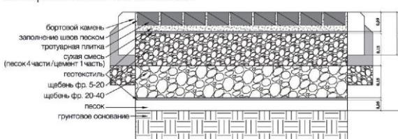
\*В случае превышения рекомендованной нагрузки на поверхность мощения, необходимо производить укладку в соответствии с инженерными рекомендациями.
