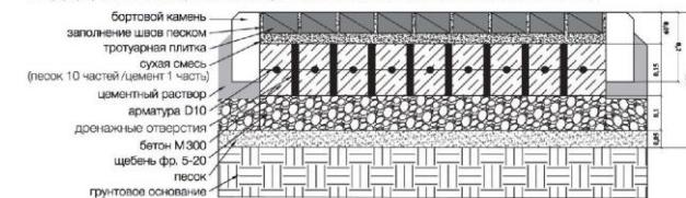
Конструкция устройства основания под пешеходные нагрузки
