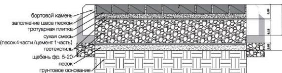
Конструкция устройства основания под автомобильные нагрузки (автомобиль до 5 тонн)\*
